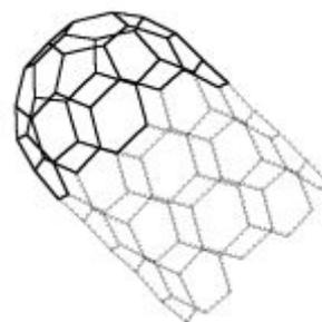
**Рис. 16.** Образование колпачков в НТ, при наличии 5-дефектов.
