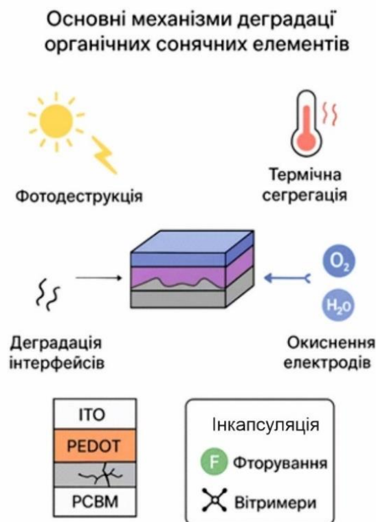
Рис. 7. Основні механізми деградації органічних сонячних елементів.
