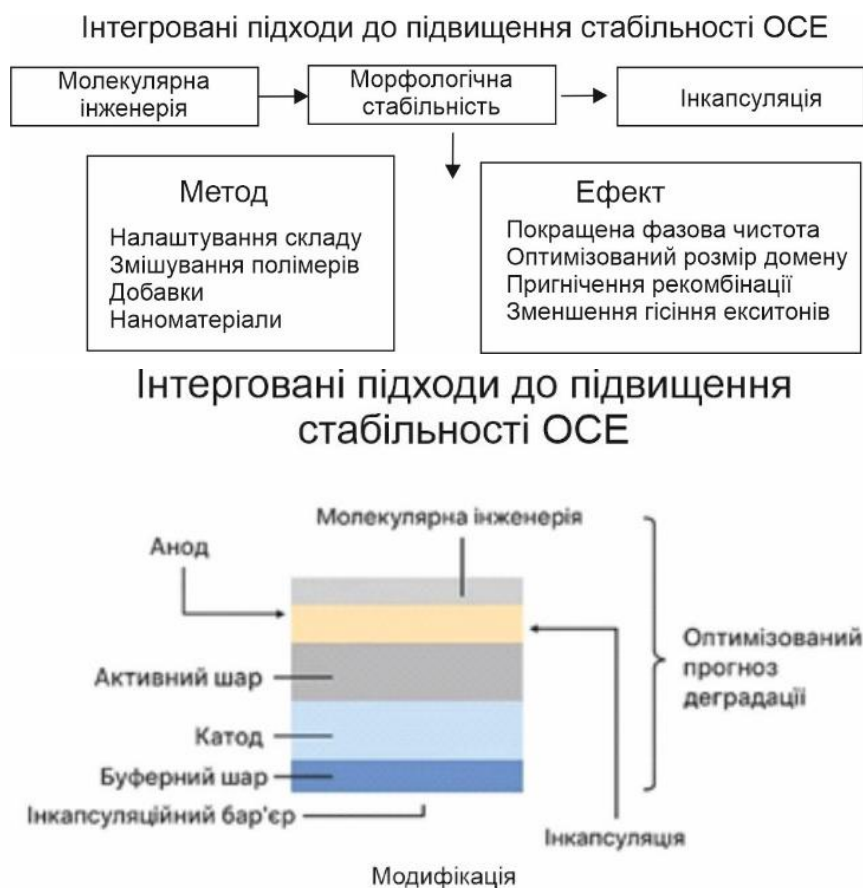
Рис. 8. Інтегровані підходи до підвищення стабільності ОСЕ (варіант А – узагальнена блок-схема; варіант Б – технічна структура шарів із позначенням методів стабілізації).
